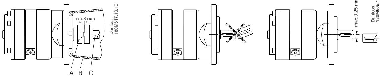
A: Elastic coupling / Elastische Kupplung / Accouplement élastique / Elastische koppeling
