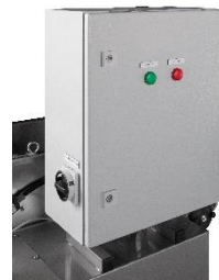
Figuur 4 Uitgebreide schakelkast
