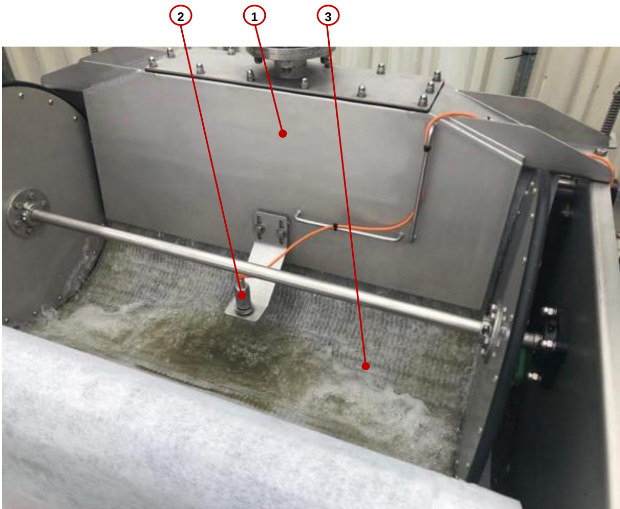
Figuur 2 Functionaliteit bandfilter
