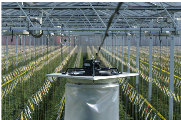
Verti-Fan® ophangen aan een rvs staalkabel
